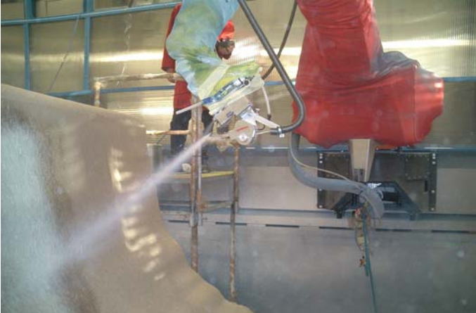
7-tengelyes Knickarm Robot az ELAN Marine cégnél
