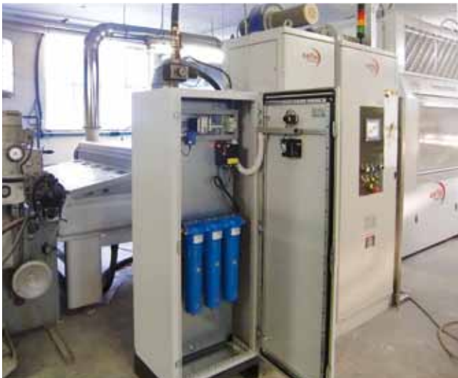
Nagy légmennyiséget kezelő airmatic rendszer, több automata szórópisztoly porlasztólevegő ellátásához
