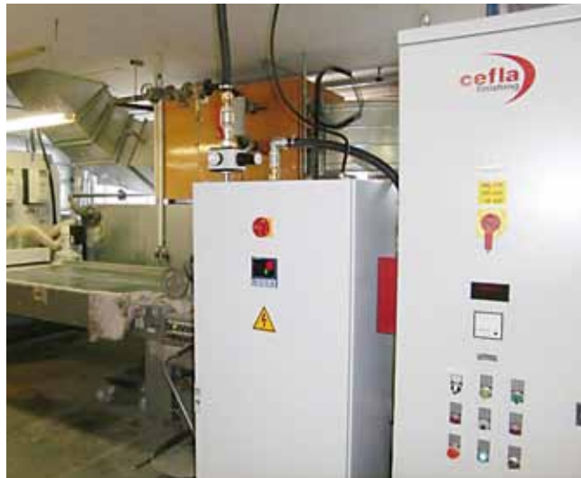
A porlasztólevegő fűtése lehetővé teszi a magas anyagviszkózitású lakkok , lazúrok egyenletesebb felhordását
