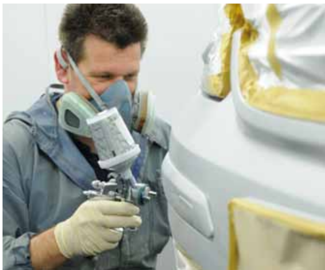
A festékködöt és a száraz szórászt jelentősen csökkenti az ionizált porlasztólevegő
