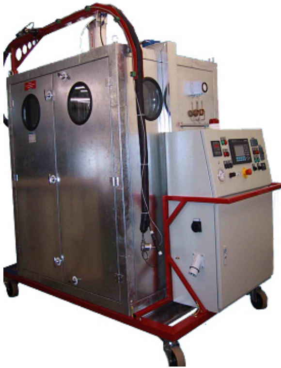
Fűtő kabinos injektáló
